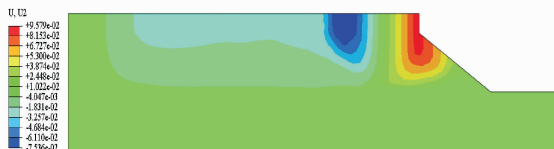
(c) 抗拉强度(100 kN/m)土工格栅工况竖向沉降云图
