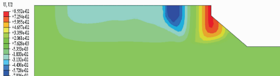
(d) 抗拉强度(300 kN/m)土工格栅工况竖向沉降云图
