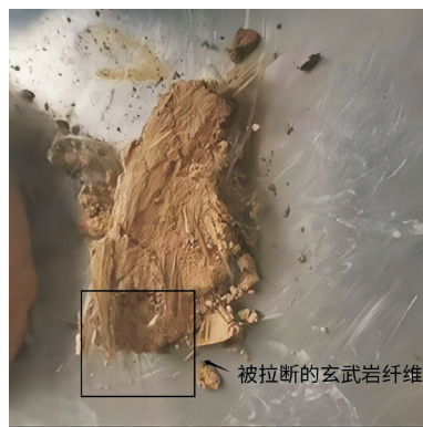
图 8 剪切面上被拉断的玄武岩纤维
