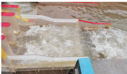
图 6 设计洪水位冲砂闸 + 两边孔泄洪闸全开泄洪消力池及池后水流流态
