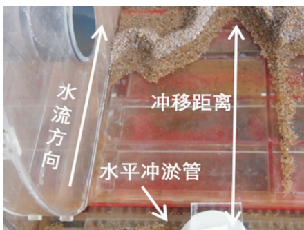
图 6 扬程 50 m 冲淤 12.5 min 试验结果
