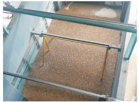
图 7 1:5 局部放大模型淤沙模拟实景
