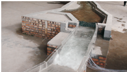
图 7 最终设计方案校核工况消力池及下游河道水流流态
