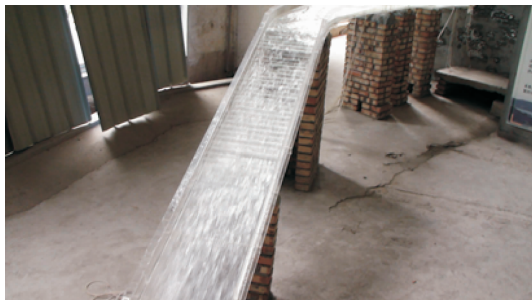
图 6 最终设计方案校核工况陡坡流道上水流流态
