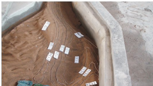
图 2 原方案校核工况护坦下游河床冲刷形态
