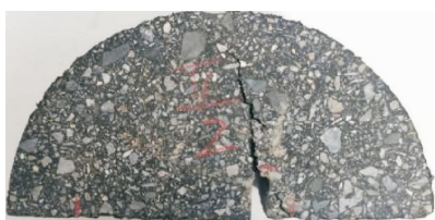
图10 II型开裂破坏试件
