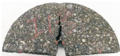
图 6 I 型开裂破坏试件
