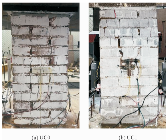
图5 UC组试件破坏形态
