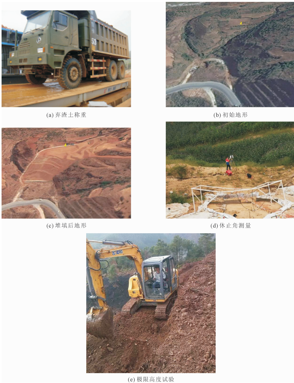
图 8 基于数字化施工的弃渣工程尺度参数试验测试图
