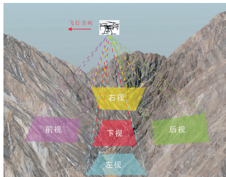
图 1 无人机多角度拍摄获取影像数据
