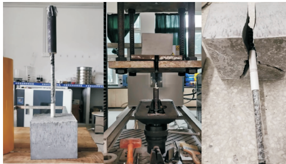
图 5 BFRP 锚杆-注浆体拉拔试样(左)、MTS 拉拔设备(中)、试样破坏图(右)
