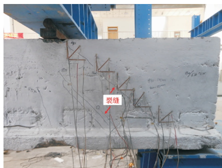
图 8 加固后空心板破坏照片
