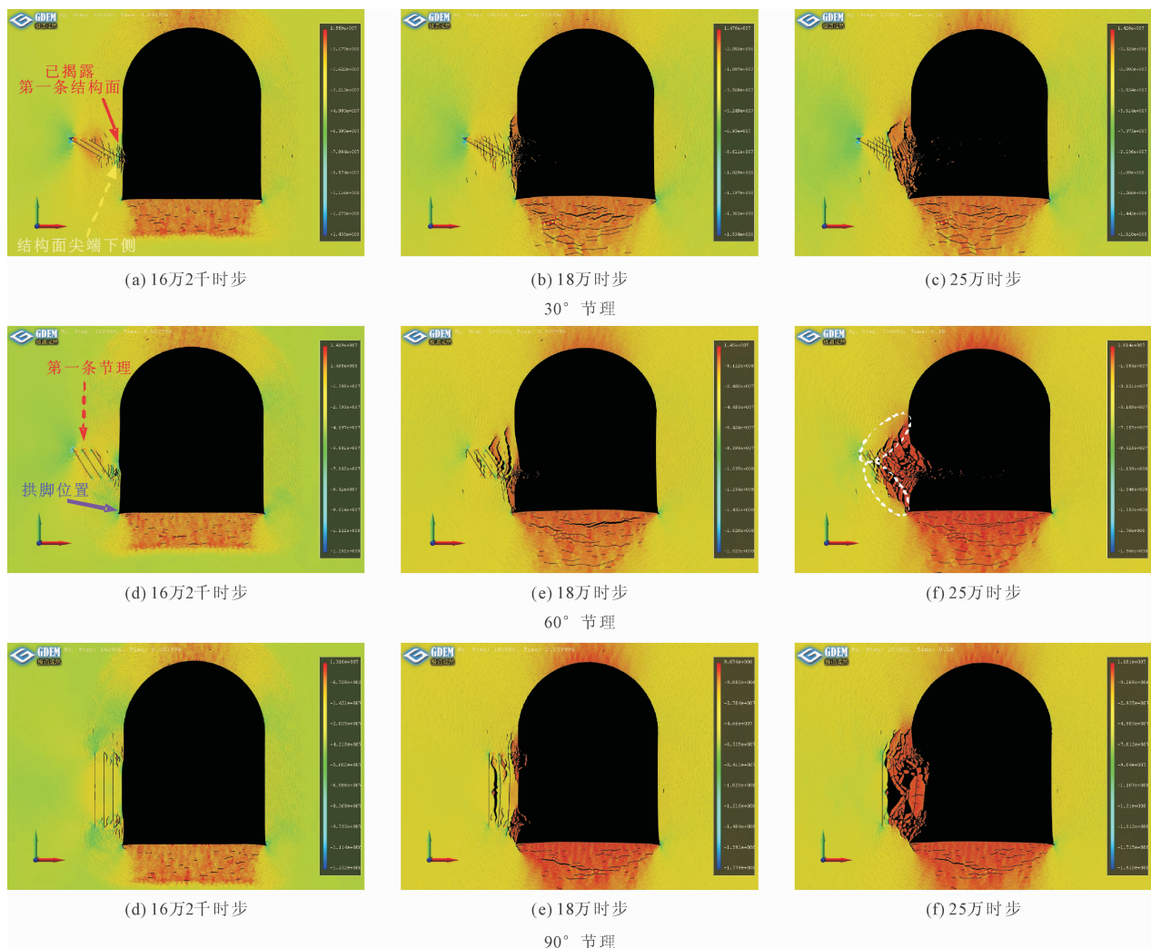
图 4 含不同倾角节理围岩破坏的演化进程 Y 方向应力云图
