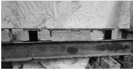
图 3 预应力加固梁试验
