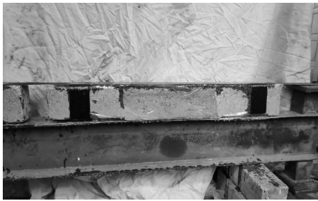
图 4 预应力加固梁试验
