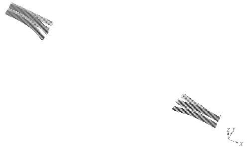
图 15 主体结构底板完成时隧道最大 Y 向水平位移变形图(10000 倍)
