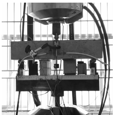
图 2 混凝土试件的安装方式
