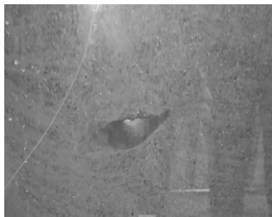
图 7 试验过程中出现的空洞
