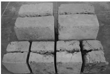
图 8 试件破坏形态
