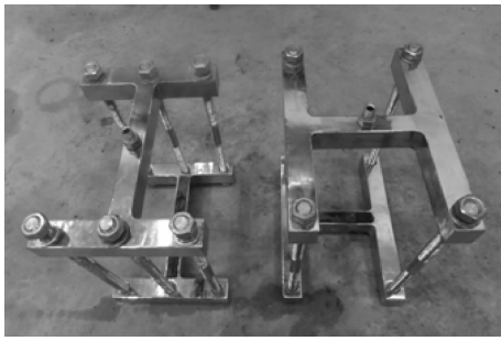
图 4 两套钢架密封装置示意图
