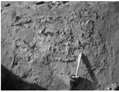
图 3 剪切试验完成后结构面擦痕和充填物示意图
