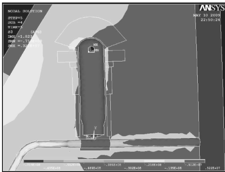
图 10 阻抗式调压井控制工况第三主应力
