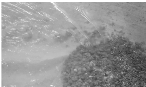
图5 向河坡靠上游侧块石首先起动
