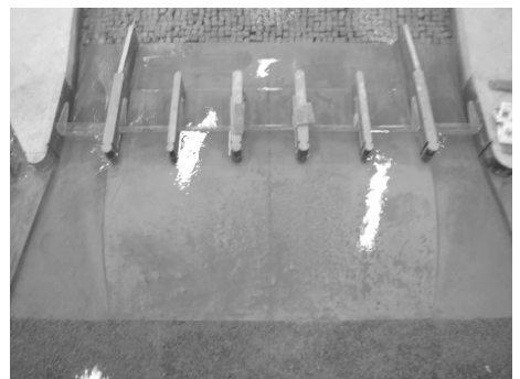
图 2 流量 71 \text{ m}^3/\text{s} 闸前泥沙淤积形态
