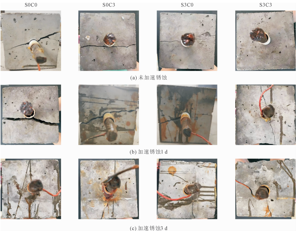
图 7 不同 NS/NC 掺量试件拔出破坏形态
