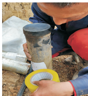
图2 垃圾土现场取样
