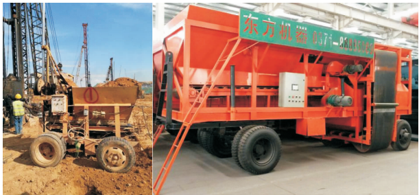
图 5 夹杆锤全自动填料机和灰土拌和机
