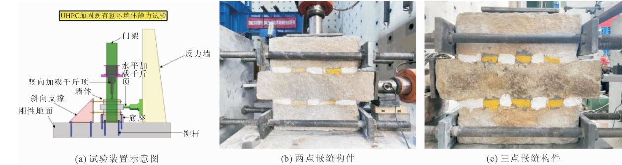
图 4 加载装置及试验构件示意图
