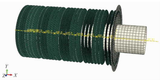
图 11 单个 DSNSD 的网格划分
