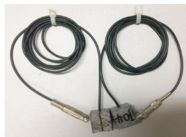
图 6 试验过程中采用的“智能骨料”
