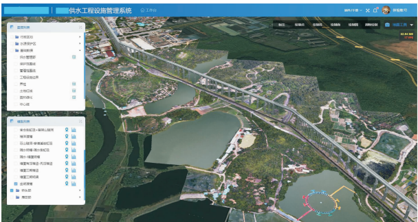
图 5 BIM 与倾斜摄影三维模型融合展示
