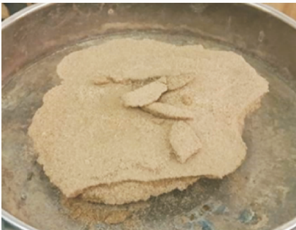
(b) 固结砂块的形状
