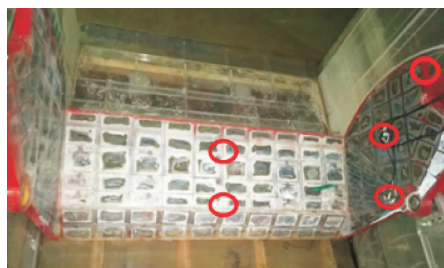
图 13 下卧门修改体型振动测点布置示意图
