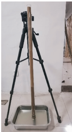
图 4 毛细管上升高度试验过程
