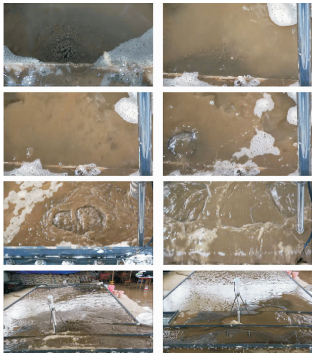
图5 管涌险情致溃全过程
