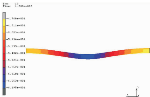
图 4 管道位移云图(变形 × 50)
