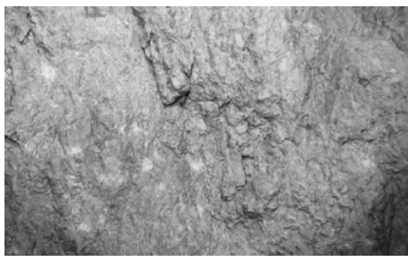
图4 远离构造带的岩石蚀变表现特征
