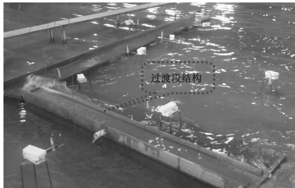
图 5 工况 1 下整体模型堤顶越浪试验效果
