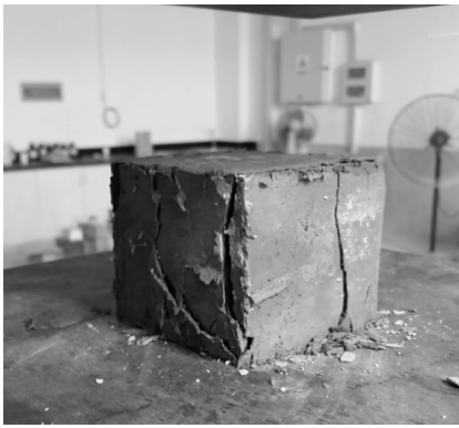
图 3 试件脆性剪切破坏
