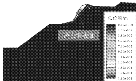
图 5 3 断面边坡潜在破坏模式(总位移云图)
