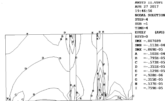
图 11 校核水位工况中墩水平位移
