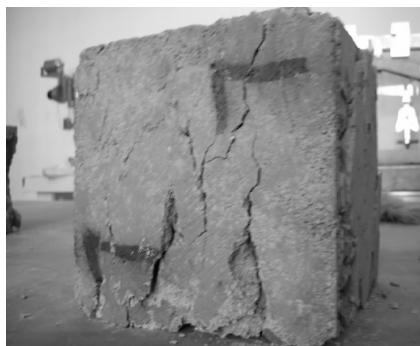
图 4 抗压破坏形态(7组)
