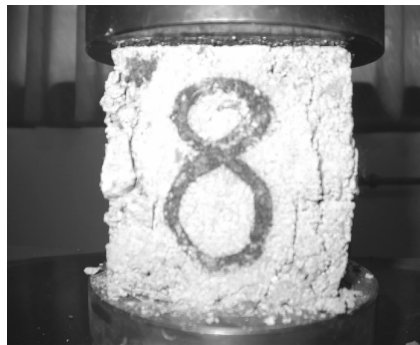
图 5 抗压破坏形态(8组)
