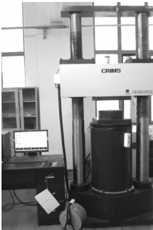
图 1 试验用 YNS-Y3000 电液伺服压力试验机
