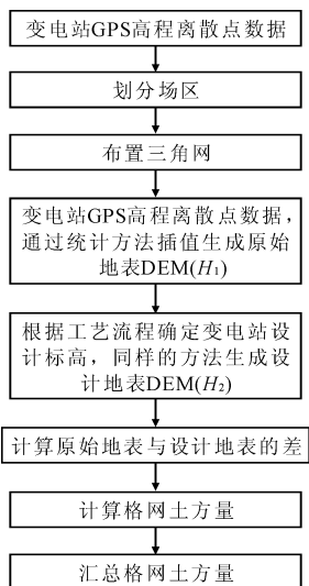
图 3 基于 HTCAD 平台的 DEM 法计算土方量流程
