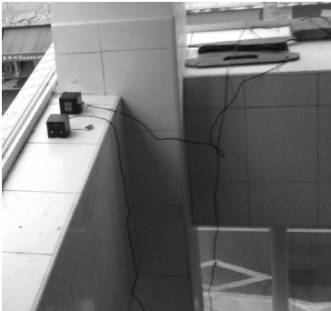
图 7 DH612 传感器现场布置
