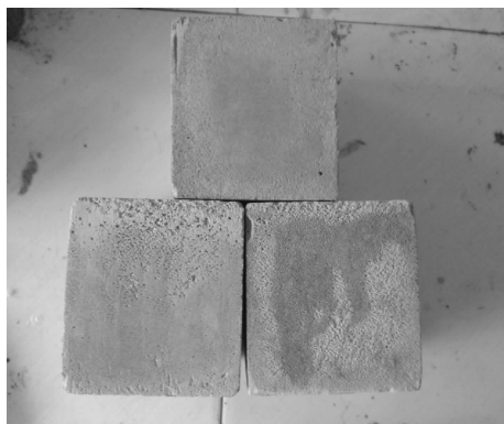
图 2 不同气泡率的气泡混凝土试样
