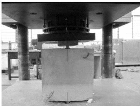
图 3 劈裂抗拉强度试件和试验装置
