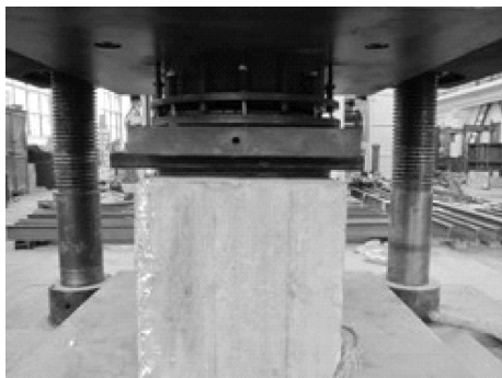
图 2 抗压强度试件和试验装置图
